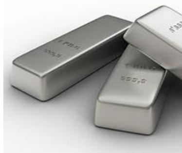
鎳的熔點高，1453 度，硬度高，延展性佳，抗強酸、鹼能力強，但導熱性能較差，同時化學活性也相當高，但會在表面形成氧化物，保護內層不被繼續氧化。且鎳與鐵一樣，具有鐵磁性，由於金屬元素中，只有鎳、鐵、鈷、釷、鈦在室溫下有磁性，又相對於鐵不易氧化，這些特性使得鎳的用途相當廣泛。
